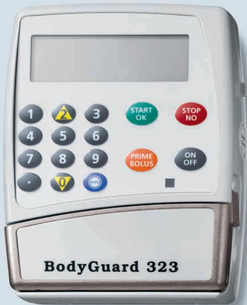
Die **BodyGuard 323** Infusionspumpe wird im ambulanten und stationären Bereich universell für die Infusionstherapie eingesetzt. Die durchdachte Konstruktion überzeugt durch überragende Linearität und komfortable Handhabung.
